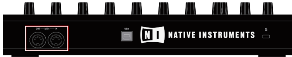
Die Rückseite des MASCHINE Controller mit dem MIDI-In
